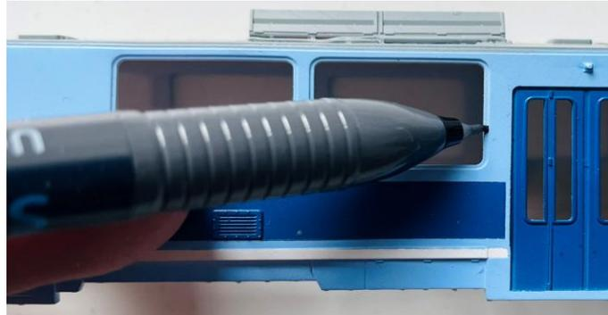
Trenne anschließend aus den beiden Acrylglas-Platten (Teile E, F) die einzelnen Fenster mit einem Bastelmesser heraus und lege sie in eine Box, Schüssel o.ä. ab, damit kein Teil verlorengeht. Entferne die weiße Schutzfolie von der Rückseite der Fenster. Anschließend entgratest du jedes einzelne Fenster, z.B. mit einer kleinen Schere.
