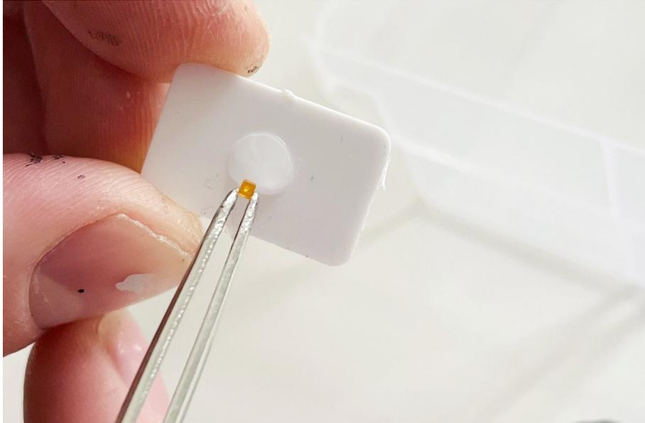
Gib etwas Sekundenkleber auf ein überschüssiges Plasteteil. Der Zapfen der transparenten Linse wird mit der Pinzette in den Kleber getaucht. Alternativ kannst du den Kleber auch mit einem Zahnstocher auf die Linse oder auf das Modell geben.
