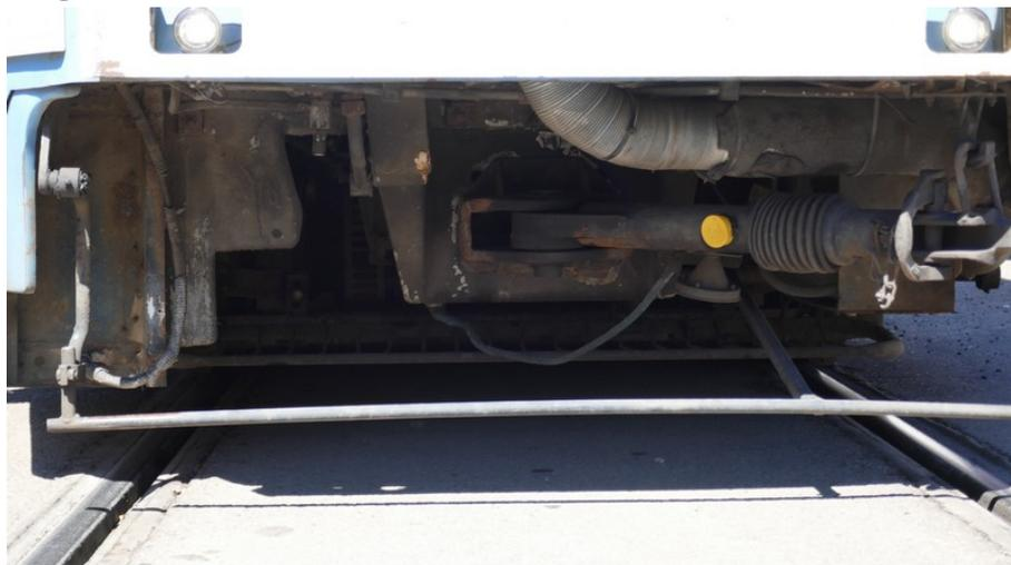
Auf dem Bild sehen wir ein Originalfahrzeug von vorn. Die Kupplung ist nach links eingeklappt.
