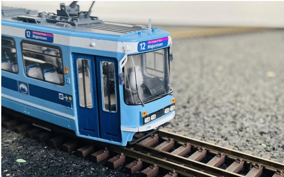
Ein Wischer steht aufrecht, der andere Wischer liegt waagrecht. Verklebt werden können die Wischer in den kleinen Löchern unter der Frontscheibe. Sinnvoll ist es, die Wischer ebenfalls an der Unterkante der Frontscheibe mit ganz wenig Sekundenkleber zu fixieren.
