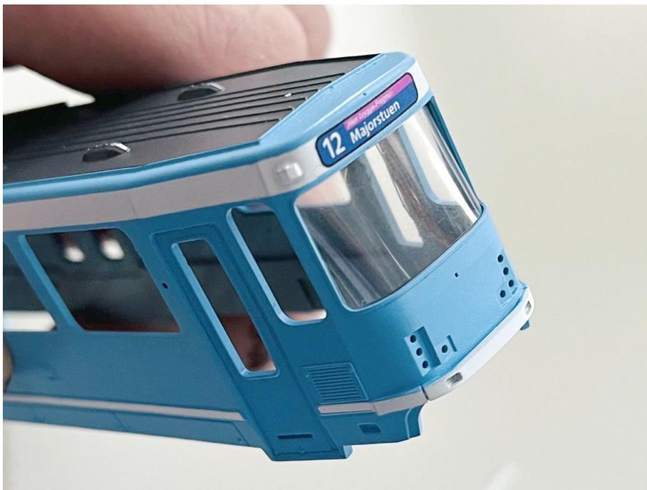
Wenn das erledigt ist, sieht das etwa so aus. Die Scheibe ist an allen Seiten im Wagenkasten eingerastet und steht unter Spannung. Sie bleibt an der gewünschten Position und muss nicht verklebt werden.
