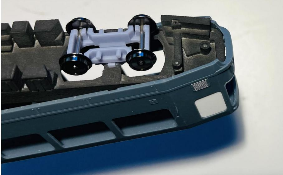
Anschließend drückt man den hinteren Teil des Gehäuses vorsichtig auf die Bodenplatte. Das Gehäuse muss man dabei mit dem Finger etwas aufspreizen.
