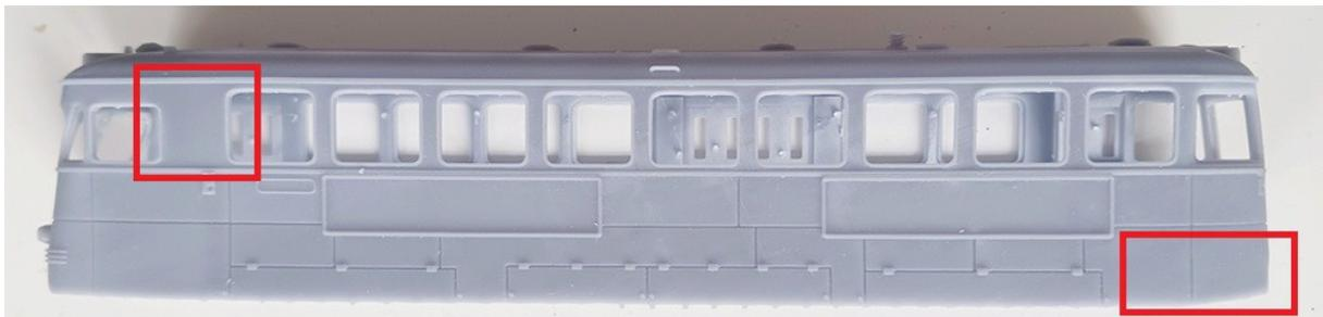
Außerdem kannst du, sofern noch vorhanden, die innere Stützstruktur aus dem Wagenkasten herausbrechen.
