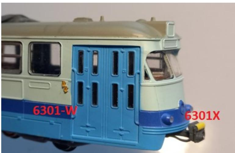
Außerdem besitzt der Wagenkasten 4 Rück- und 8 Blinkleuchten (6301-Y, 6301-W). Deren Löcher bohrst du zunächst mit einem 0,8mm-Bohrer nach. Sei vorsichtig dabei, damit die Löcher nicht ausbrechen. Anschließend kannst du die roten bzw. orangen Leuchten einsetzen. Sollten die Teile lose sitzen, kannst du die Unterseite der Leuchten mittels eines Zahnstochers mit ein wenig Sekundenkleber benetzen und dann erneut einkleben.
